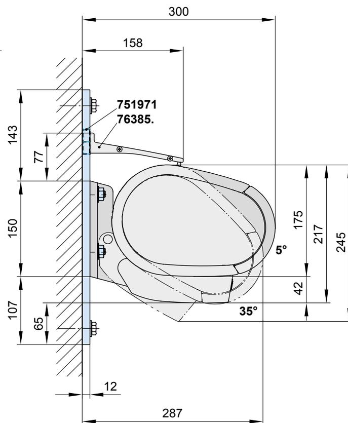
**76385.** = Wandanschlussprofil (Standardbreite = Markisenbreite (M); bis max. 70° Markisenneigung)
