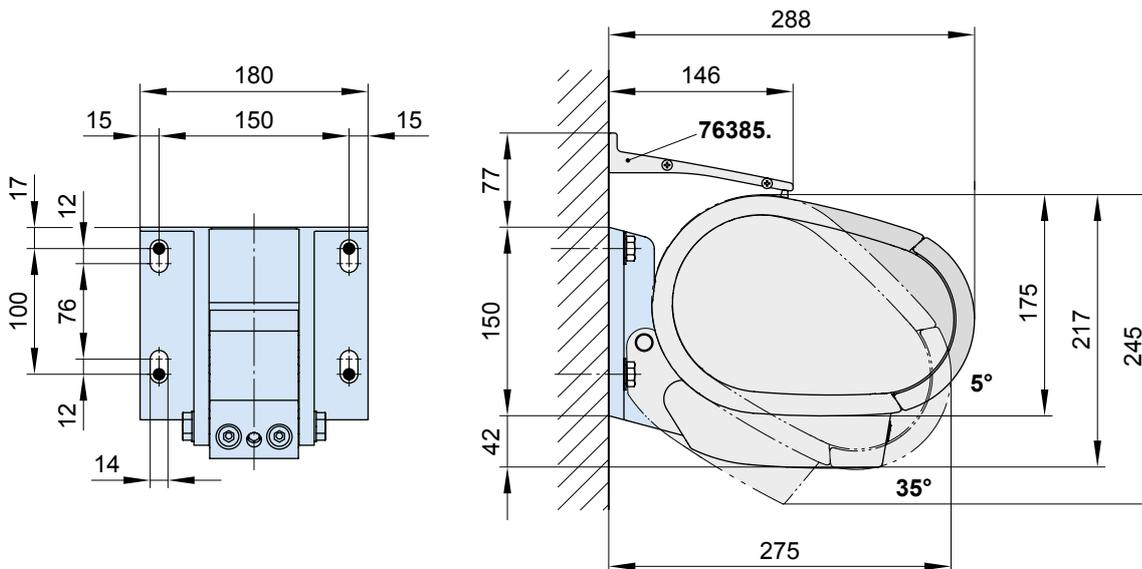
76385. = Wandanschlussprofil (Standardbreite = Markisenbreite (M); bis max. 70° Markisenneigung)
