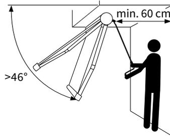
Achtung! Bei einer Neigungseinstellung über 46° zur Waagerechten muss für eine Handbedienung bei Funkmotor mit Nothandkurbelantrieb hinter der Markise ein begehbare Bereich von 60 cm vorhanden sein.
