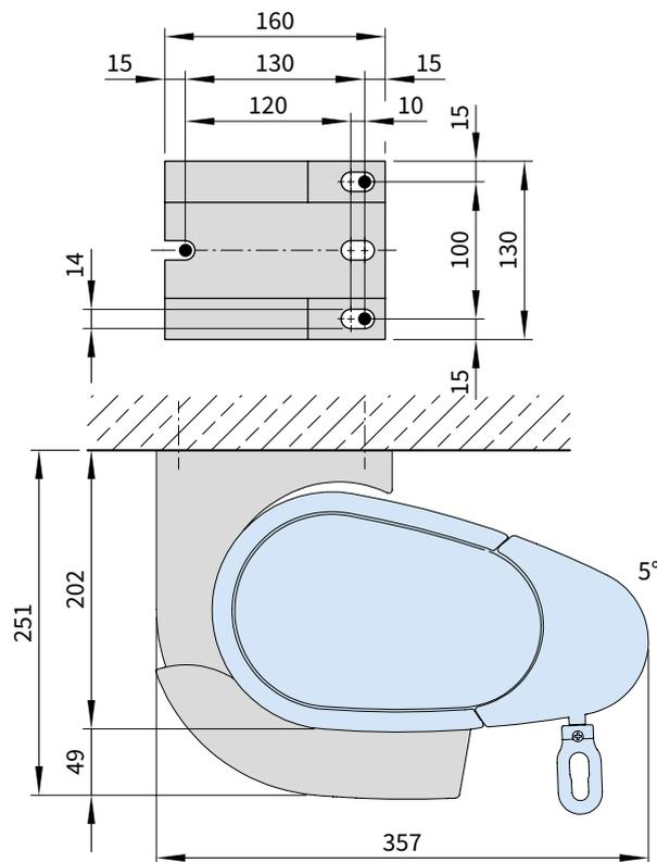
76385. = Wandanschlussprofil (Standardbreite = Markisenbreite (M); bis max. 70° Markisenneigung)
