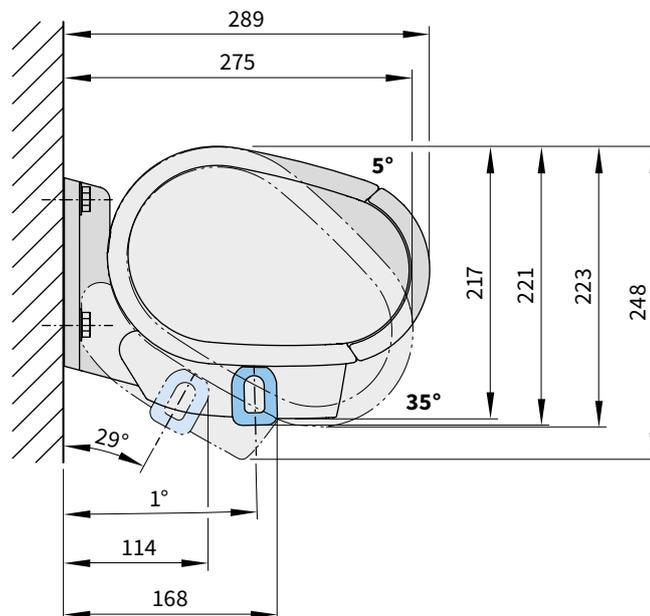
**Achtung!** Bei einer Wandmontage der markilux 6000 mit Funkmotor mit Nothandkurbel ist eine maximale Markisenneigung von 35° möglich!
