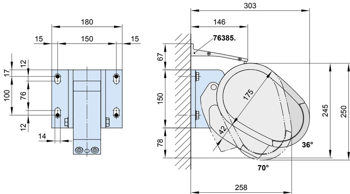
**76385.** = Wandanschlussprofil (Standardbreite = Markisenbreite (M); bis max. 70° Markisenneigung)
