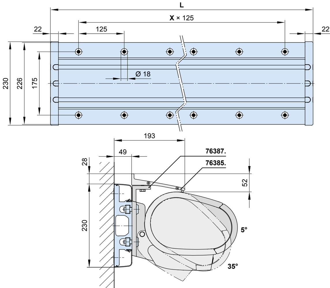
**76385.** = Wandanschlussprofil (Standardbreite = Markisenbreite (**M**); bis max. 70° Markisenneigung)
