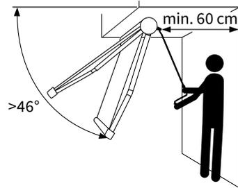
Achtung! Bei einer Neigungseinstellung über 46° zur Waagerechten muss für eine Handbedienung bei Funkmotor mit Nothandkurbelantrieb hinter der Markise ein begehbarer Bereich von 60 cm vorhanden sein.
