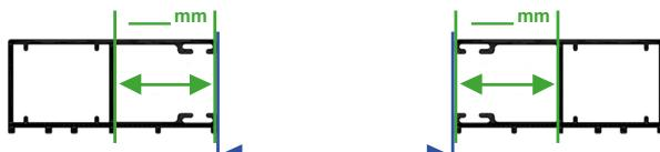
**Achtung:** Bei Angabe des Lichtenmaß für die Höhe muss der Kasteneinstand dazu gerechnet und der Führungsschieneneinstand bekannt gegeben werden:
