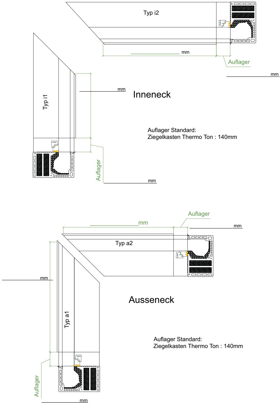
**Standardauflager bei ThermoTon – 140 mm**
