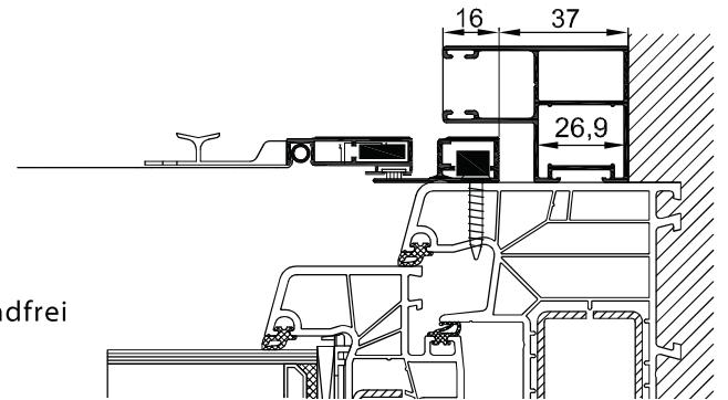
ACHTUNG: Drehtür muss links und rechts min. 16mm auf dem Stock aufliegen um diese einwandfrei befestigen zu können.
